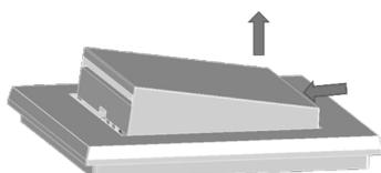
Drücken Sie nun die geschlossene Seite nach innen und ziehen Sie die Abdeckung aus der Verrastung. Halten Sie zusätzlich den Abdeckrahmen fest, da dieser nach Abziehen der Abdeckung nicht mehr fixiert ist.
