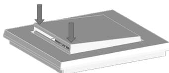
Si le côté fermé est verrouillé, répétez ces étapes avec le côté ouvert (en haut). Utilisez les parties extérieures du couvercle comme point de pression afin de ne pas l'endommager. Ce côté s'enclenche également lorsque vous appuyez dessus verticalement.
