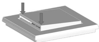
Als de gesloten zijde vergrendeld is, herhaalt u deze stappen met de open zijde (bovenkant). Gebruik de buitenste delen van de afdekking als drukpunt om deze niet te beschadigen. Deze zijde klikt ook vast als je hem verticaal aandrukt.
