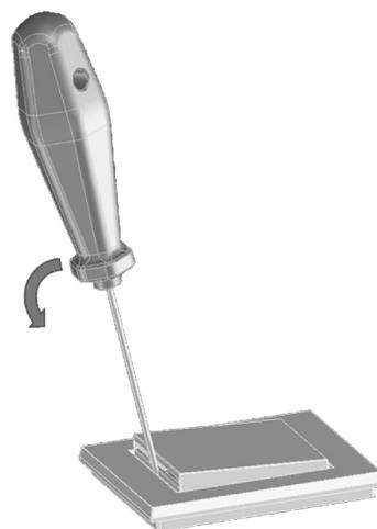
Placez un tournevis au centre du côté ouvert, entre le cadre du couvercle et la fente pour carte de chambre. Relâchez les crochets de verrouillage sur le couvercle avec un léger mouvement de levage. Cela peut entraîner une légère déformation qui n'entraîne pas de dommages.
