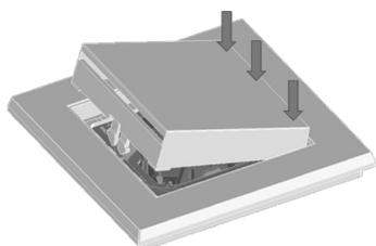
Halten Sie den Abdeckrahmen in gewünschter Position an den Taster und drücken Sie die Rasthaken der geschlossenen Seite der Abdeckung zuerst in die dafür vorgesehene Aussparung. Durch senkrechtes Drücken auf die Abdeckung rastet diese fest ein.
