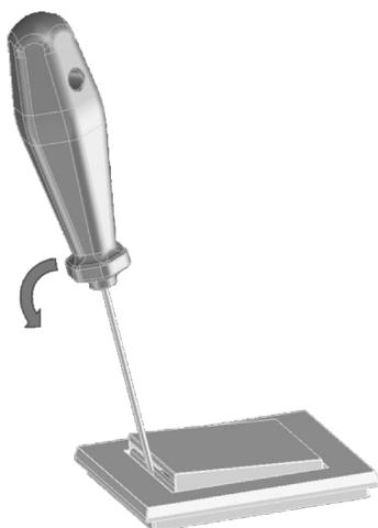
Setzen sie einen Schraubendreher mittig an der geöffneten Seite, zwischen Rahmen und Zimmerkarteneinführung, an. Lösen Sie mit einer vorsichtigen Hebelbewegung die Rasthaken der Abdeckung. Hierbei kann es zu einer leichten Verformung kommen, die keine Beschädigung nach sich zieht.
