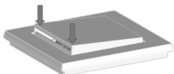
Ist die geschlossene Seite eingerastet wiederholen Sie den Vorgang mit der geöffneten Seite. Nutzen Sie hierbei als Druckpunkt die äußeren Stellen der Abdeckung um diese nicht zu beschädigen. Durch senkrechtes Drücken rastet auch diese Seite fest ein.
