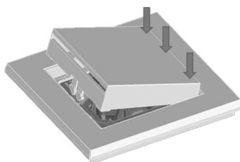
Maintenez le cadre du couvercle dans la position souhaitée sur la base et appuyez sur les crochets de verrouillage du côté fermé (en bas) du couvercle dans l'écroulement prévu. Il s'enclenche en appuyant verticalement sur le couvercle.
