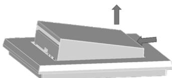
Druk nu de gesloten kant naar binnen en trek het deksel uit de vergrendeling. Houd ook het afdekraam vast, want deze zit niet meer vast nadat de afdekking is verwijderd.
