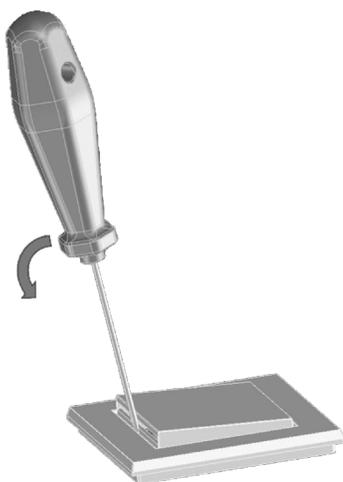
Plaats een schroevendraaier in het midden van de open zijde, tussen het afdekraam en de kamerkaartsleuf. Maak de vergrendelingshaken op het deksel los met een voorzichtige hef beweging. Dit kan leiden tot een lichte vervorming die niet tot schade leidt.
