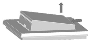
Maintenant, poussez le côté fermé vers l'intérieur et retirez le couvercle de la serrure. Tenez également le cadre du couvercle, car il ne sera pas fixé une fois le couvercle retiré.
