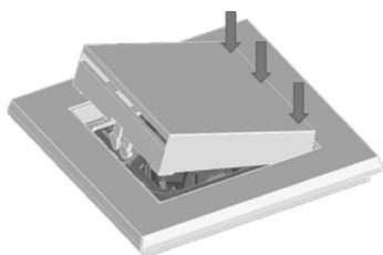
Houd het afdekraam in de gewenste positie op de sokkel en druk de vergrendelhaken aan de gesloten zijde (onderkant) van de afdekking in de daarvoor bestemde uitsparing. Door verticaal op het deksel te drukken klikt het vast.
