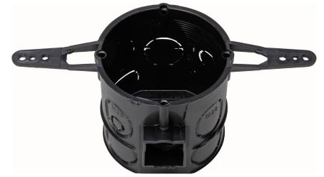
UP Schalterdose mit 2 Nagellaschen als Montagehilfsmittel, Durchmesser: 60mm, Dosentiefe: 62mm, schwarz, IP20, 2 Schraubmöglichkeiten oder Klammerbefestigung, mit festen Eingängen, Mittelabstand 71mm horizontal und vertikal, mit 5x M16 und 7x M20 Ausbrechöffnungen
