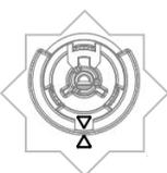
Bei einer eventuellen Demontage sollte zur Erleichterung das Dekorteil mit Drehknopf und Schalterraahmen zusammen abgehoben werden.
