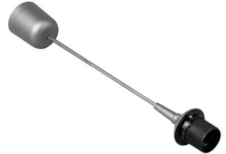
Schnurpendel für Lampenschirm, E27-Fassung mit Schirmträgereing, mit Ø65mm-Deckenbaldachin, 55cm leichte PVC-Schlauchleitung H03VV-F2x0, 75mm<sup>2</sup>, mit Zugentlastung, max. 60W, 10A, 250V, Farbe: silber
