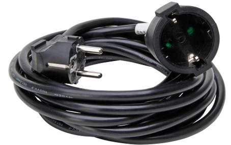
Verlängerung, Schutzkontakt-Winkelstecker und Schutzkontakt-Kupplung mit Leitung H05VV-F 3Gx1,5mm<sup>2</sup>, mit erhöhtem Berührungsschutz, Zuleitung: 5m, 16A, 250V~, Schutzart IP20, Farbe: schwarz
