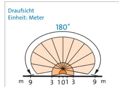
Einbauhöhe: 1,8 m bis 2 m
