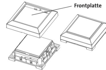
Sollte zu einem späteren Zeitpunkt eine Demontage erforderlich sein, führen Sie dazu den Schraubendreher vorsichtig von vorne zwischen Karabinerhaken und Modul, drücken Sie den Haken nach außen und heben Sie das Modul heraus.
