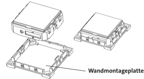
Schritt 5: Danach rasten Sie die Frontplatte auf das Sensormodul und die Wandhalterung wie unten gezeigt. Beachten Sie, dass Frontplatte und Wandhalterung mit einer Kerbe versehen sind, um eine korrekte Ausrichtung zu gewährleisten.
